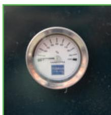
Jauge de contenu hydrostatique à lecture permanente installée de série sur nos cuves à huiles de série ORB
